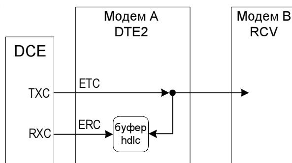
Подключение к произвольному DCE, связная синхронизация
