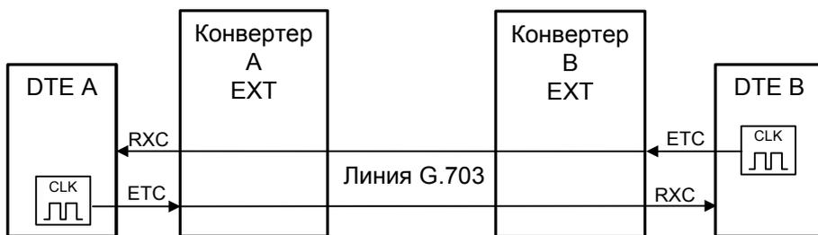
Рис. 5.2-6. Раздельная синхронизация от DTE А и DTE В
