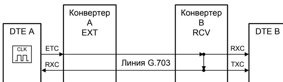
Рис. 5.2-2. Единая синхронизация от DTE А
