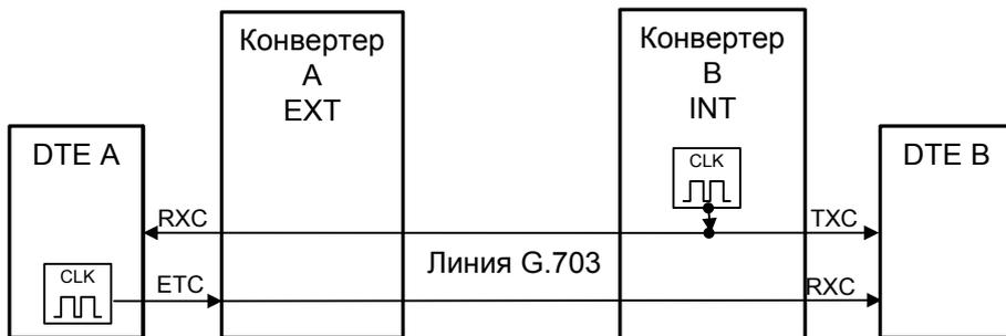
Рис. 5.2-5. Раздельная синхронизация от DTE А и конвертера В
