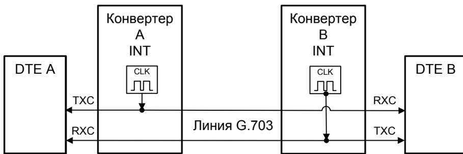
Рис. 5.2-4. Раздельная синхронизация от конвертеров А и В
