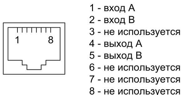
Рис. 4.3-4. Разъём линии G.703
