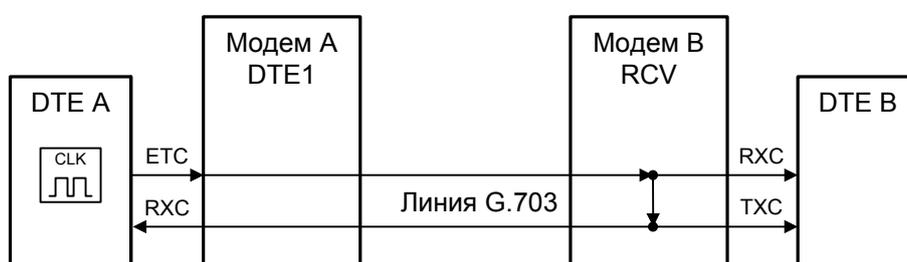
Рис. 5.2-2. Единая синхронизация от DTE А
