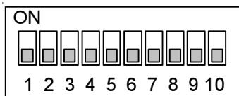
В настольном исполнении микропереключатели расположены на нижней крышке модема, при исполнении в каркасе - на плате со стороны монтажа деталей.
