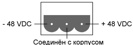
Соответствующая съёмная часть терминального блока разъёма питания поставляется в комплекте с устройством.
