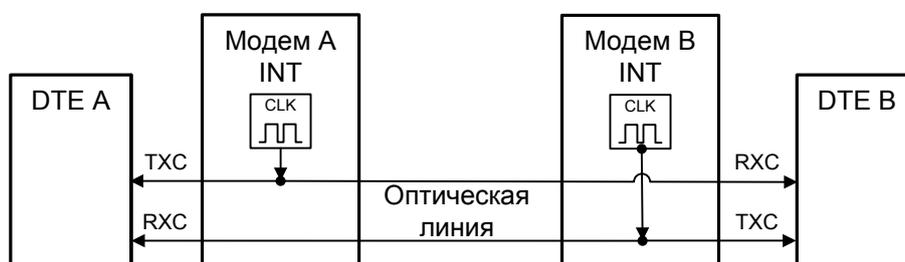
Рис. 5.2-3. Раздельная синхронизация от модемов А и В
