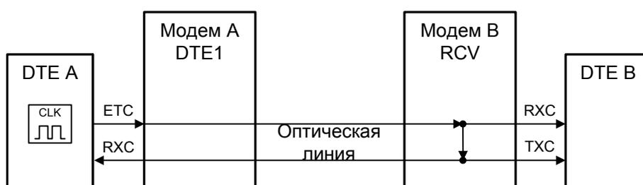
Рис. 5.2-2. Единая синхронизация от DTE А
