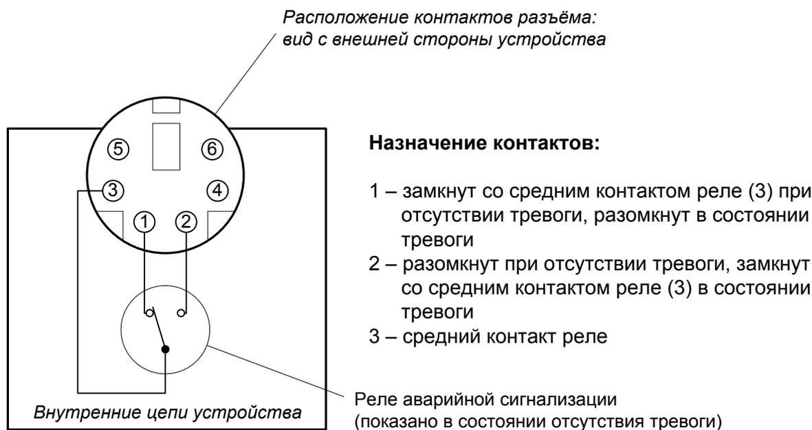
Рис. 4.4-2. Разъём порта аварийной сигнализации
