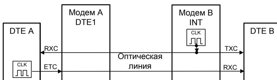
Рис. 5.2-4. Раздельная синхронизация от DTE А и модема В
