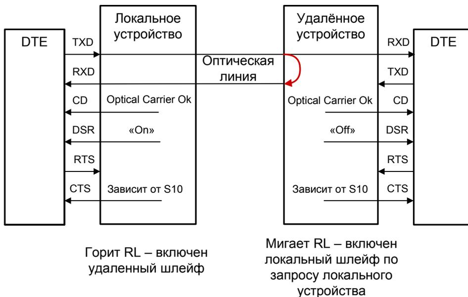
Рис. 5.5-4. Удалённый шлейф на оптической линии
