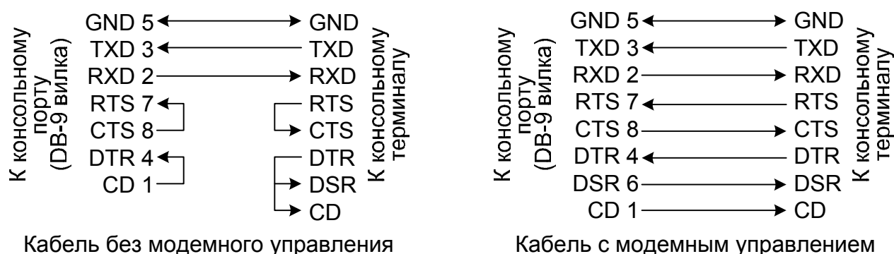
Рис. 3.5-3. Схемы консольных кабелей
