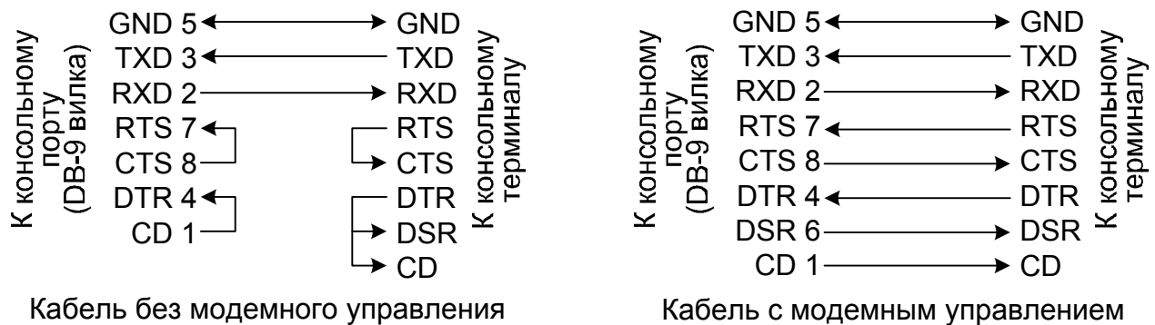
Рис. 2.5-6. Схемы консольных кабелей
