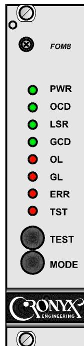
**Кнопка TST** - включение измерителя уровня ошибок (BER-тестер). При нажатии кнопки TST BER-тестер последовательно подключается к линии G.703, затем к оптическому каналу. Если BER-тестер включен, горит/мигает индикатор TST. При этом в выбранную линию передаются тестовые данные, а принятые из линии данные сравниваются с переданными и в случае несравнения загорается индикатор ERR.
