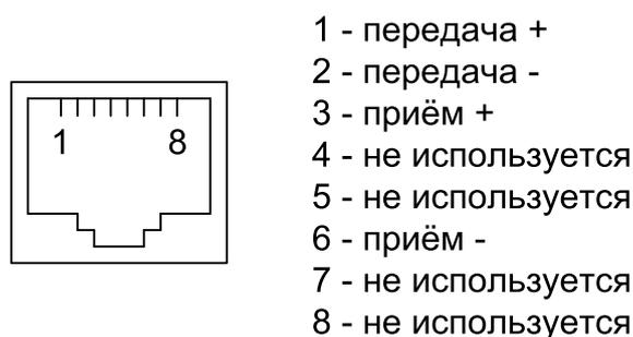
Рис. 3.3-3. Разъём RJ-45
