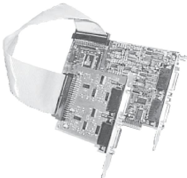
Рисунок 1: Сигма-22 и расширитель Delta2, соединенные шлейфом
