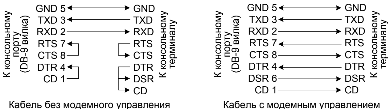
Рис. 3.3-5. Схемы консольных кабелей
