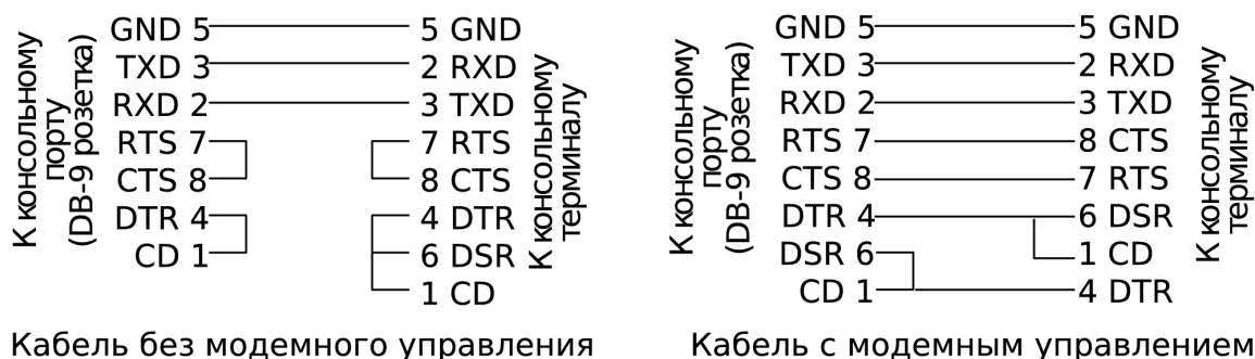
Рис. 3.3-3 Схемы консольных кабелей
